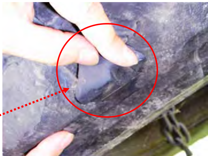
タイヤ片がピッタリと合った「タイヤ片」を事故車両と直接照合したのは今回が初めて
