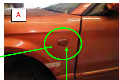
左フロントのサイドマーカー(ウインカー)フェンダーに埋め込まれている。
