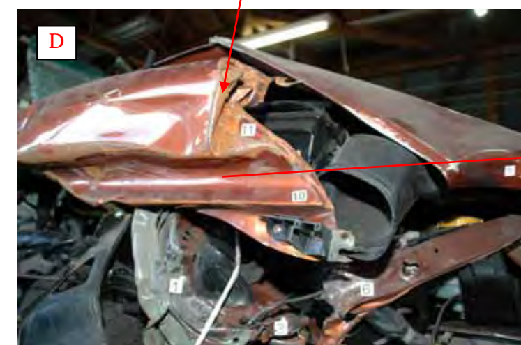
サイドメンバー（フェンダー下の部材）への丸いタイヤ痕「資料46参照」
