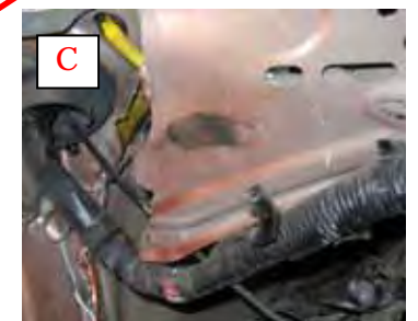
サイドメンバー（フェンダー下の部材）への丸いタイヤ痕「資料46参照」
